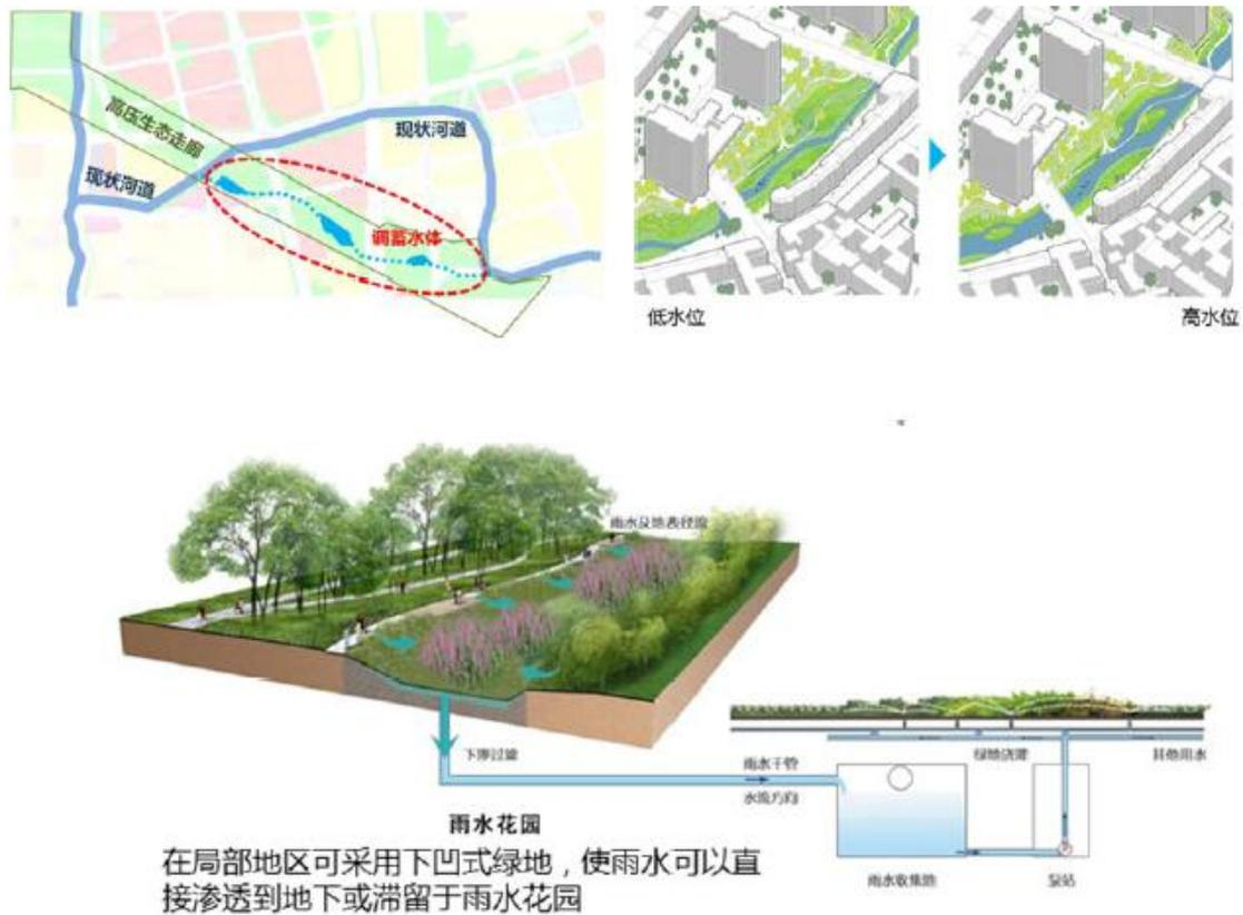
图 8.4.1 高压生态走廊雨水调蓄示意图
